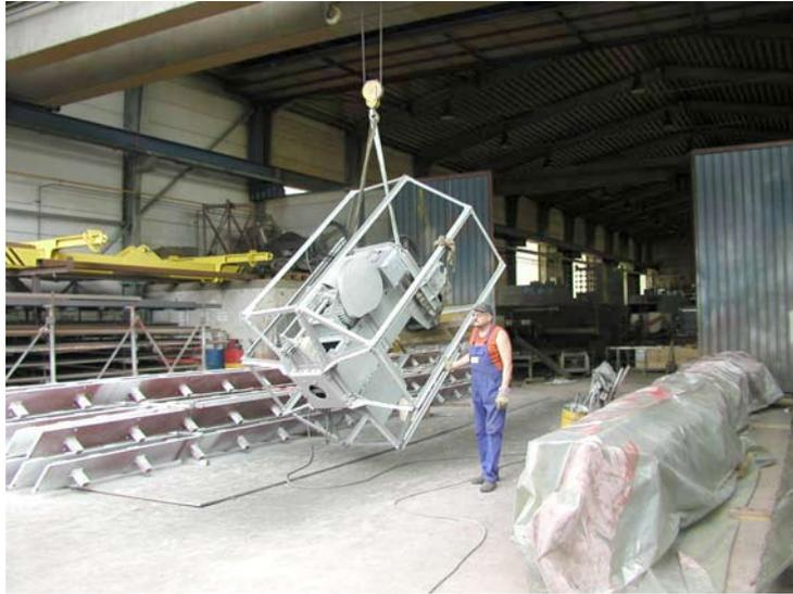
Der Kran ist im Maschinengrau endlackiert, die elektrische Verkabelung ist fertig gestellt, der Probelauf war erfolgreich. Der Kran wird zum Transport ins DDM ausgeliefert.
