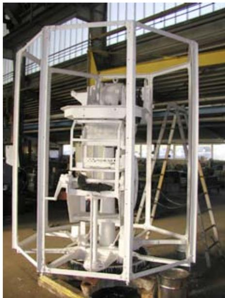
Nach Sandstrahlung und Grundierung der Eisenteile ist das tragende Gerüst mit der Königsachse zu erkennen.
