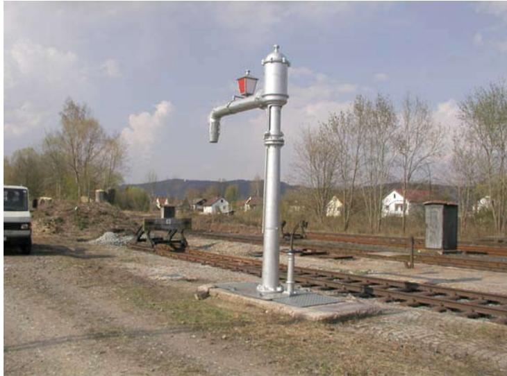
Wasserkran Nr. 2 steht. Der Ausleger trägt das Signal Sh2 in Form der typischen Wasserkranlaterne, die hier originalgetreu mit einem Petroleumbrenner beleuchtet wird.
