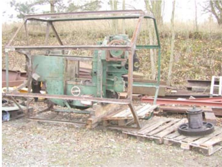
Während der laufenden Baumaßnahmen auf dem Kohlenhofgelände wird der Einheitsbekohlungskran durch die Fa. Heinzl, Thurnau, technisch restauriert. Der desolate Zustand des gut 70 Jahre alten Kranes zeigt sich nach Entfernung der morschen Holzteile nach Anlieferung des Kranes in die Fachfirma im Spätherbst 2004. Mit den rekonstruktiven Konservierungsarbeiten, die sich über ein halbes Jahr erstrecken, wird sofort begonnen.
