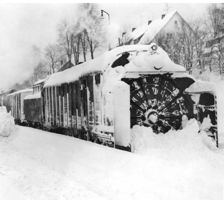
Schneepflug des Bw Kirchenlaibach, geschoben von einer Dampflok der Reihe 64 im Einsatz im Bahnhof Thiersheim an der heute nicht mehr existierenden Bahnlinie Selb – Hohenbrunn, ca. 1969
